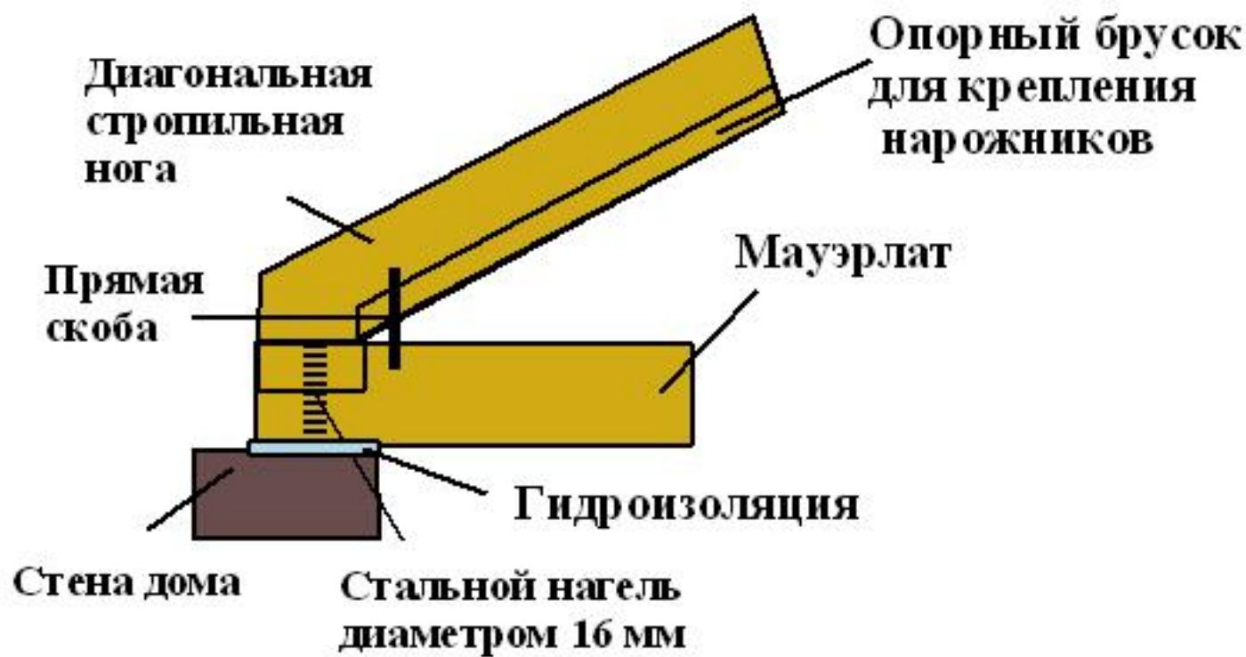
Опираие диагональной стропильной ноги на врезанную балку
