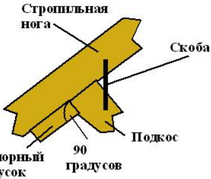
Опираение стропильной ноги из брусьев на подкос без врубкн.
